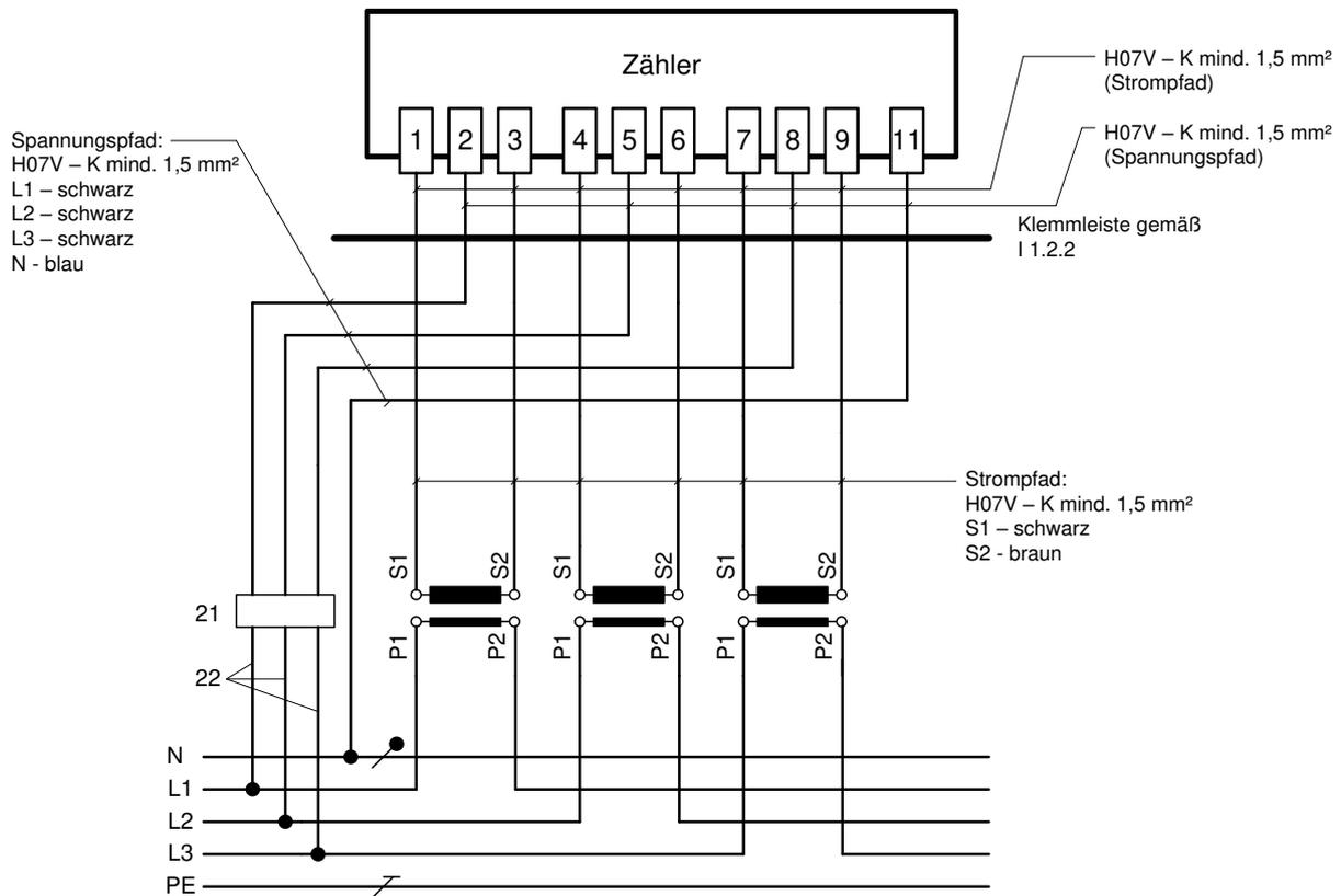
21) Spannungspfadsicherung: 3-polig LS-Schalter 6 A (Ik mind. 25 kA) oder D01 / 10 A nach Vorgabe des NB
