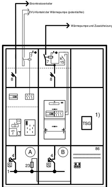
Ⓐ Wärmepumpe, Steuerung über potentialfreiem Kontakt mit Koppelrelais und Regelung der Anlage
